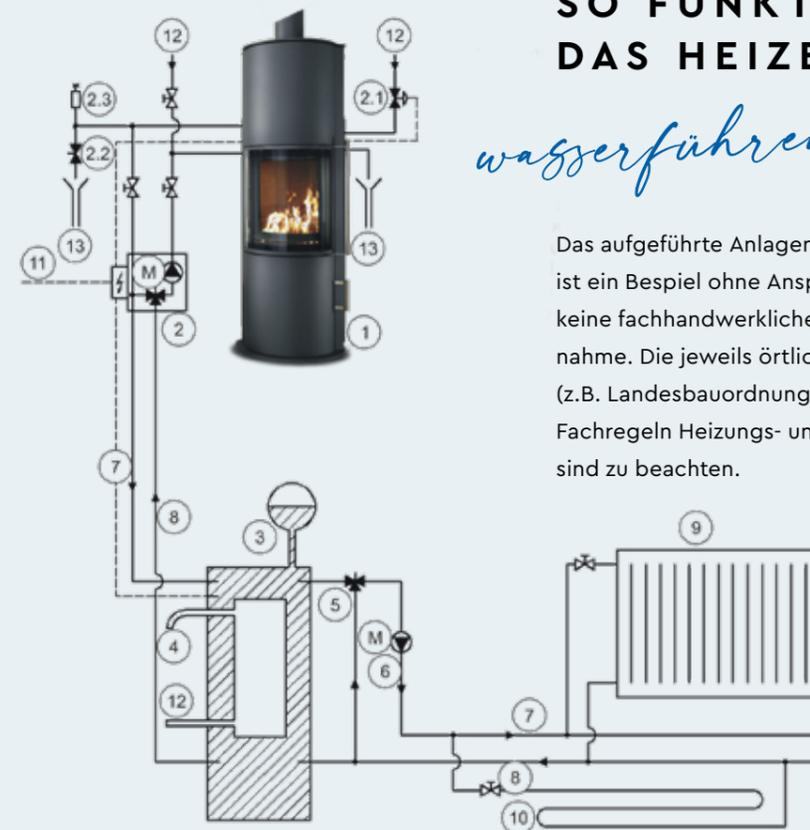
1 Kaminofen 2 Komplettsteuerung 2.1 Thermische Ablaufsicherung 2.2 Sicherheitsventil 2.3 Schnellentlüfter
